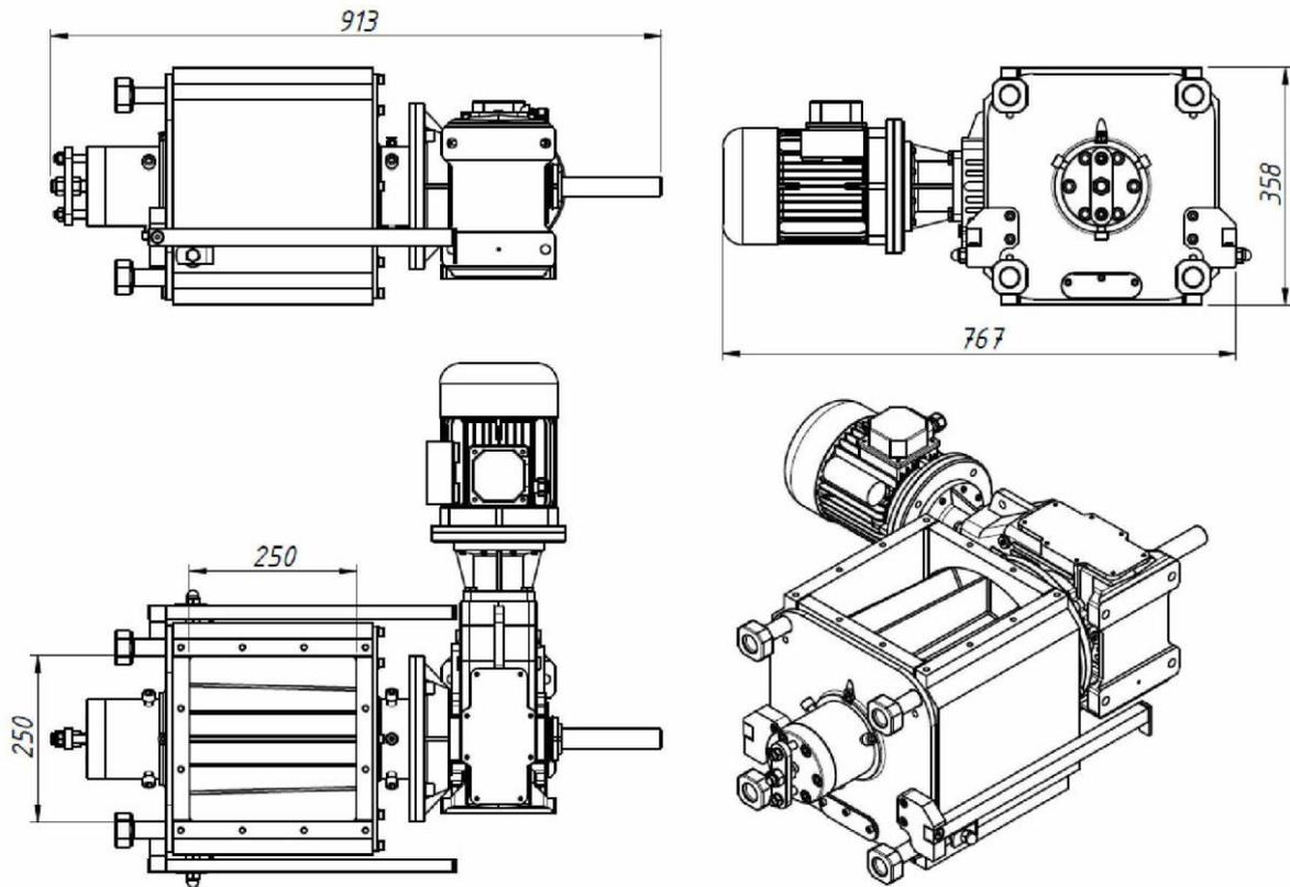
Capacidade de 14 Litros Por Volta Com Motoredutor de 3 cv
